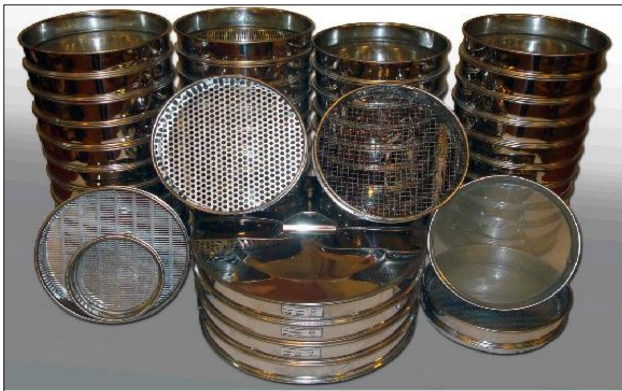
Рис.61. Набор сит для определения гранулометрического состава.
