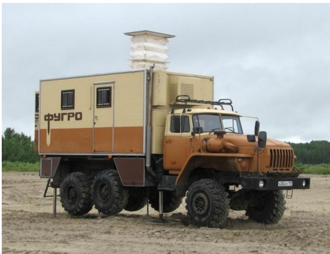
Рис.35. Установка статического зондирования.
